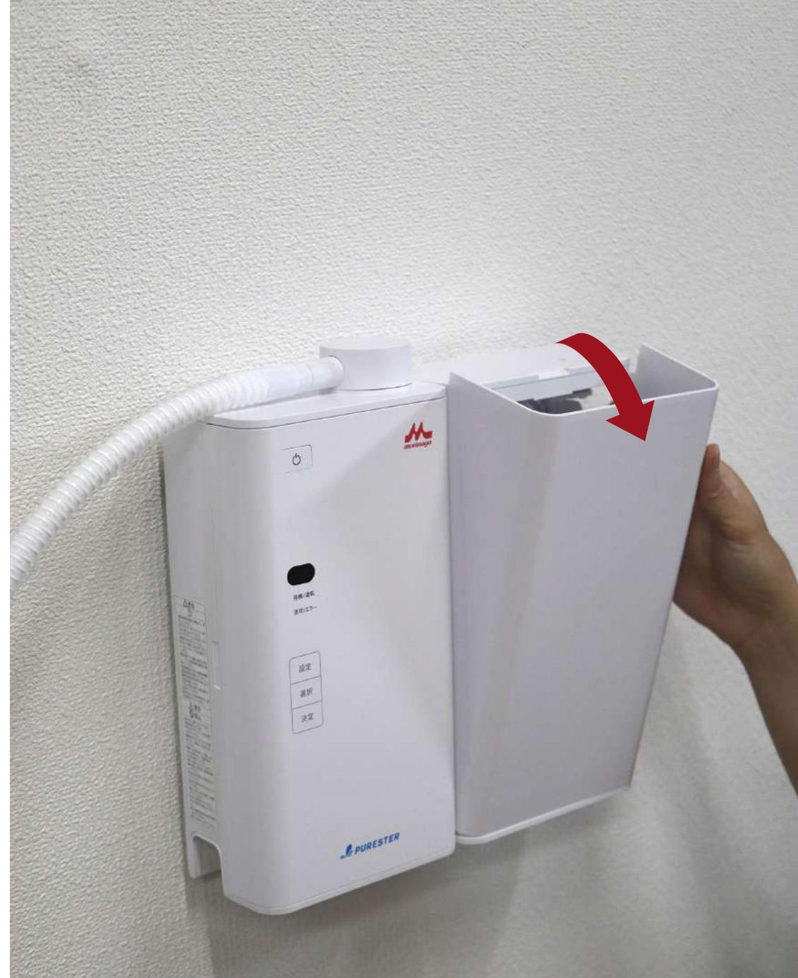
フロントパネルをはずす。 ※電源スイッチを「オフ」にしてから作業する
