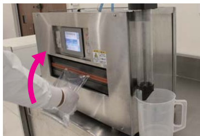
②プレスが閉じたら、すぐに袋の底を上を持ち上げ、水を吸引させ、吸水が終わったら、すぐに袋を下げる。(上げたままだと水がこぼれる。)
