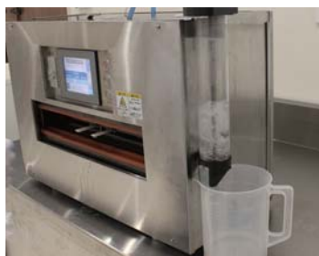
③本体右側の排水フィルターから、汚れたぬるま湯が排水される。 (水がきれいになるまで、①～③を繰り返す)
