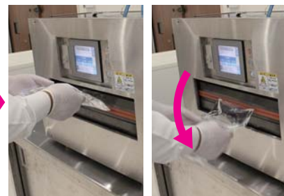
②プレスが閉じたら、すぐに袋の底を上を持ち上げ、水を吸引させ、吸水が終わったら、すぐに袋を下げる。(上げたままだと水がこぼれる。)
