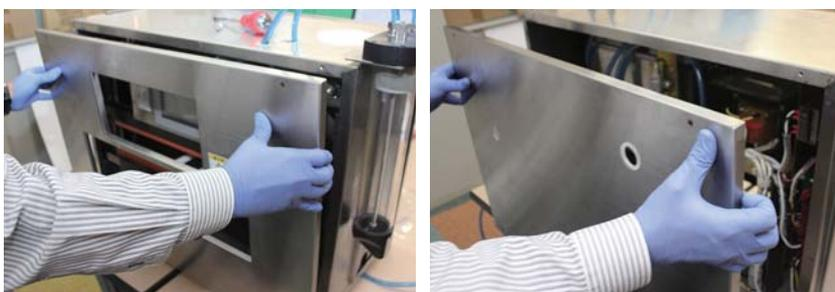
3 背面右下の端子台からヒーター線と温度センサー線を外し、線を前面に引き出しておく。
