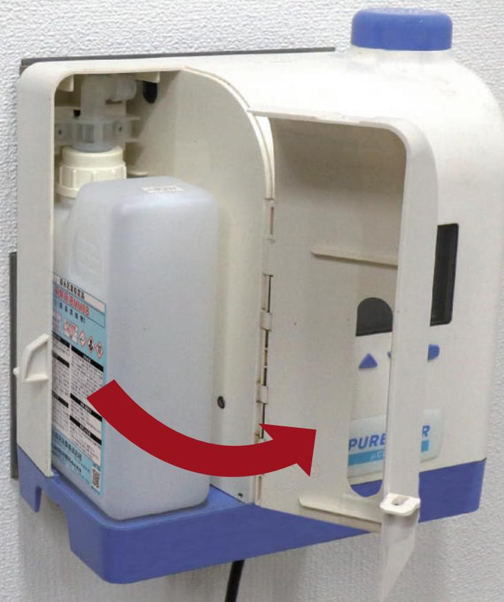
電源スイッチを「オフ」にしてから、薬液ボトル収納カバーを開ける。
