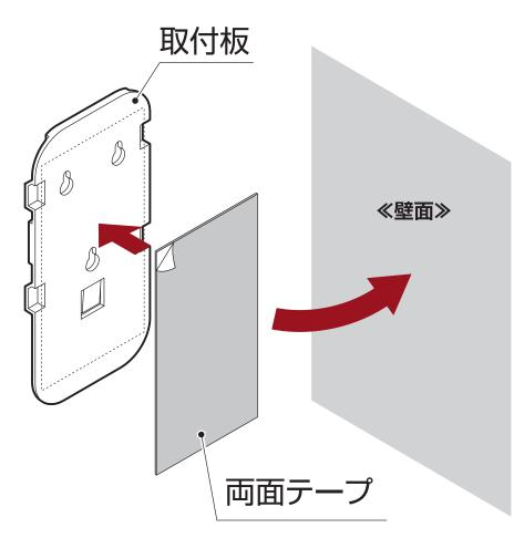
取付ける高さに注意して、付属のアルコールシートで取付け板および、取付け部分をふき上げた後、10分間放置します。
