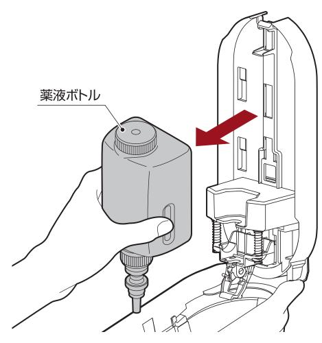
ストッパーを開けて薬液ボトルを取り外します。
