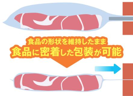
2本のノズルから空気を吸い込み包装する脱気方式です。熱いものもわずか5~7秒ほどで包装ができます。
